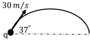
د) جسم قذف من النقطة (q) كما في الشكل المجاور بسرعة  $30 \text{ m/s}$  بزاوية  $(37^\circ)$  عن الأفق. احسب:
